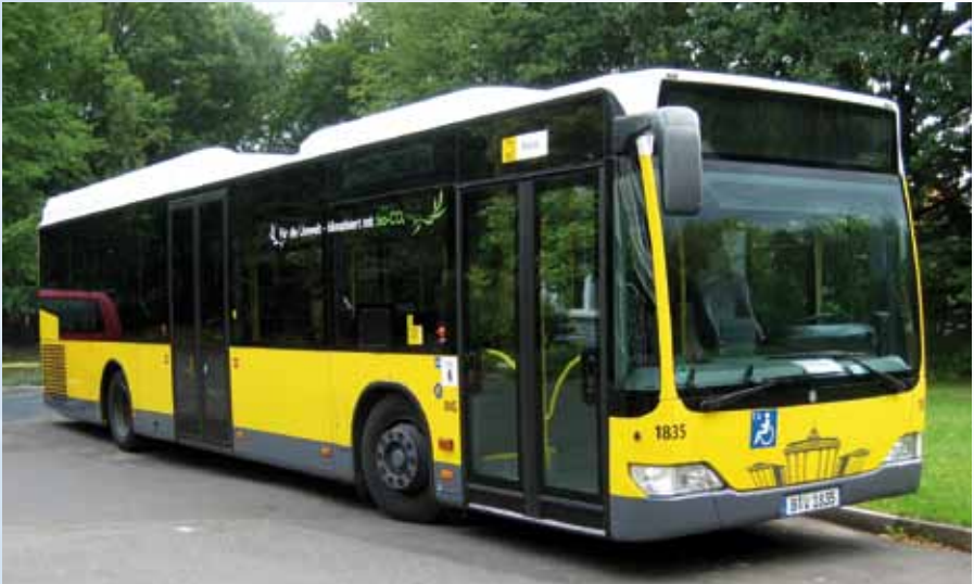
Mehrere BVG-Busse fahren mit CO 2 -Klimaanlage
